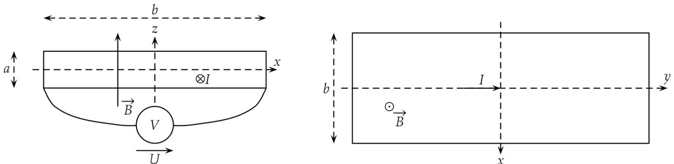
Une nappe conductrice comportant  $n = 10^{22}$  électrons de conduction par unité de volume est parcourue par un courant  $I = 1 \text{ A}$  est placée dans une zone de champ  $\vec{B} = B_0 \cdot \vec{e}_z$ .
