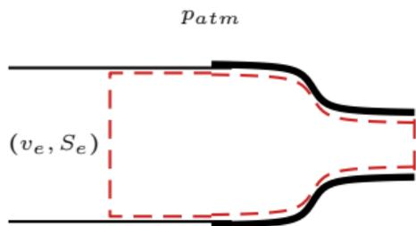
Une conduite de section  $S_e$  est terminée par un embout en caoutchouc de section en sortie  $S_s < S_e$ . On note  $\alpha = \frac{S_e}{S_s}$ . On considère l'écoulement parfait, irrotationnel en régime permanent avec un débit  $D_m$
