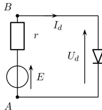
Une diode jonction P-N est placée aux bornes d'un réseau électrique modélisé par une générateur réel de tension de *fem*  $E = 1,2 \text{ V}$  et de résistance interne  $r = 40 \Omega$  entre  $A$  et  $B$ . Déterminer graphiquement le point de fonctionnement pour la diode associée au réseau
