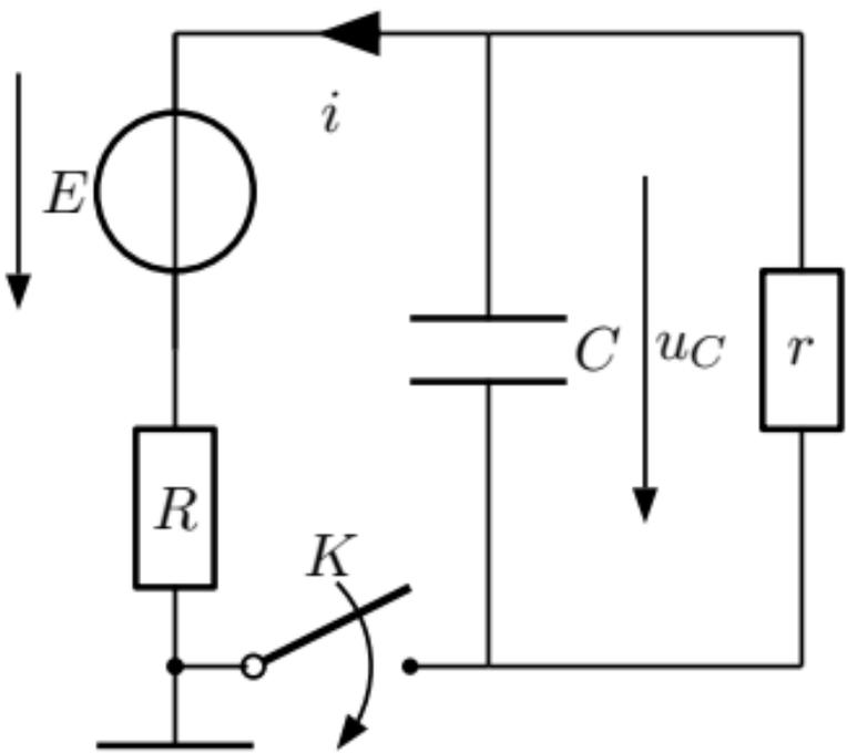
Soit un condensateur de capacité  $C$ , et de résistance de fuite  $r$ . Pour  $t < 0$  l'interrupteur est ouvert. À l'instant  $t = 0$ , on ferme l'interrupteur.
