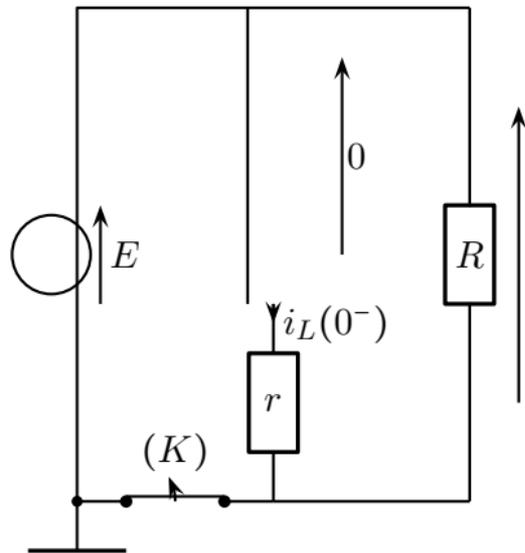
L'intensité traversant la bobine est nécessairement continue. Il s'agit du régime permanent, la bobine idéale est donc modélisable par un fil. On a donc à cet instant  $E - r.i_L(0^-) = 0$ , soit  $i_L(0^-) = \frac{E}{r}$
