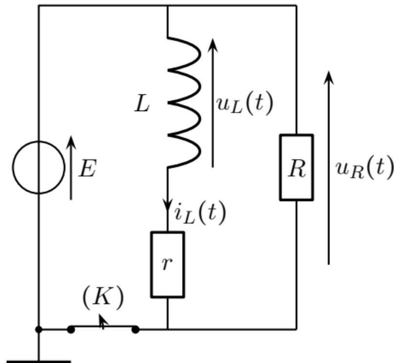
L'interrupteur ( $K$ ) est fermé depuis une durée longue. On ouvre l'interrupteur à  $t = 0$
