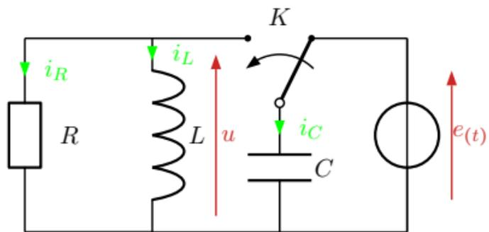
Le condensateur étant aux bornes de l'alimentation, on bascule l'interrupteur à l'instant  $t = 0$ .
