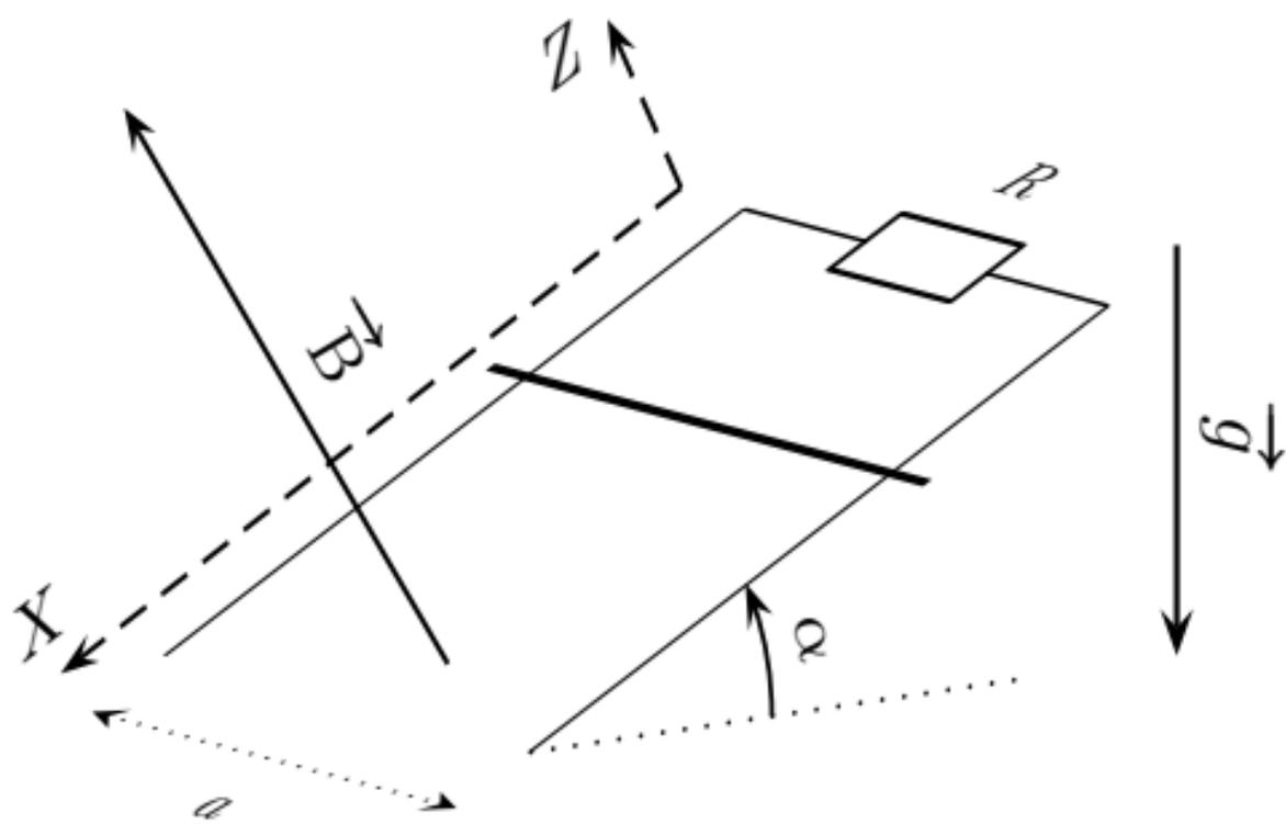
Un circuit électrique est composé de 2 rails distants de  $a$  reliés par une résistance  $R$  et d'une barre glissant sans frottement sur les rails avec une vitesse  $\vec{v} = \dot{x} \cdot \vec{e}_x$ . Le champ magnétique stationnaire et uniforme  $\vec{B} = B_0 \cdot \vec{u}_z$  est normal au plan  $(XOY)$  du circuit électrique.
