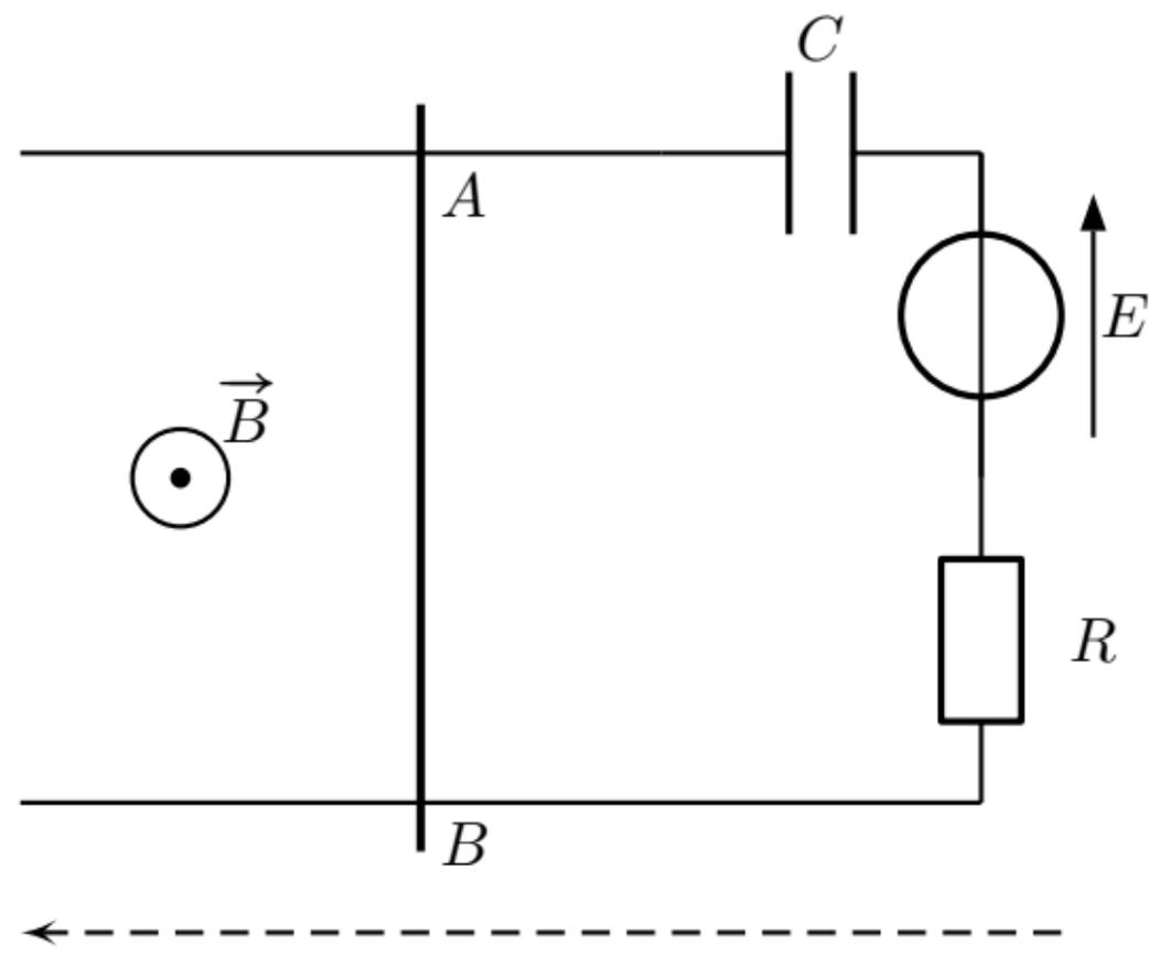
On considère 2 rails parallèles, dans le plan  $xOy$ , distants de  $L = 1 \text{ m}$  sur lesquels peut glisser une barre mobile  $AB$  de masse  $m$ . L'ensemble est placé dans un champ magnétique  $\vec{B} = B_0 \cdot \vec{u}_z$  uniforme. La position de la barre est définie par l'abscisse  $x$  du point  $A$ . Le condensateur est initialement déchargé.
