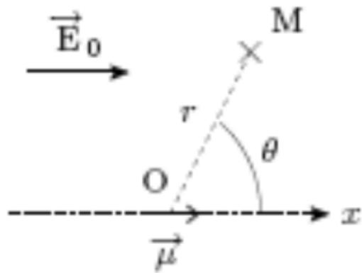
Une molécule polaire de moment dipolaire  $\vec{\mu}$  est placée à l'origine  $O$  d'un axe  $(Ox)$ , son moment dipolaire étant orienté suivant cet axe. On applique un champ électrostatique uniforme  $\vec{E}_0 = E_0 \vec{u}_x$ . On repère la position d'un point  $M$  par ses coordonnées polaires  $(r, \theta)$ .
