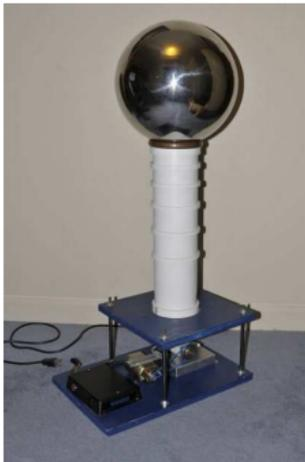
Le glissement d'une courroie isolante sur un barreau lié à la sphère métallique permet d'accumuler une charge  $Q$  à la surface de la sphère. Ce système crée donc une différence de potentiel  $U$  extrêmement importante entre la sphère et une autre électrode. Ce système a constitué la première génération d'accélérateurs de particules.
