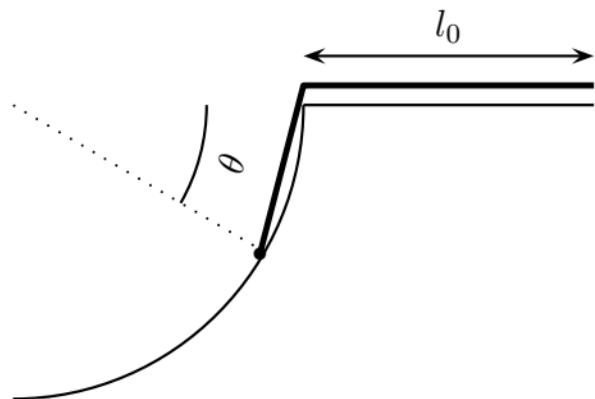
Une masse  $m$  glisse sans frottement sur un arc de cercle de rayon  $a$  dans le plan vertical. Cette masse est attachée à un élastique de longueur à vide  $l_0$  qui ayant une longueur  $l$  exerce sur la masse une force de norme  $k \cdot (l - l_0)$ .
