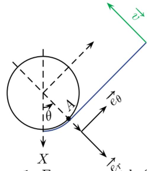
Un fil de longueur initiale  $l_0 = 1 \text{ m}$  est lié d'une part à une bobine de rayon  $a = 10 \text{ cm}$  et d'autre part à un mobile ponctuel  $M$  de masse  $m = 500 \text{ g}$ .  $M$  peut glisser sans frottement sur un plan horizontal.
