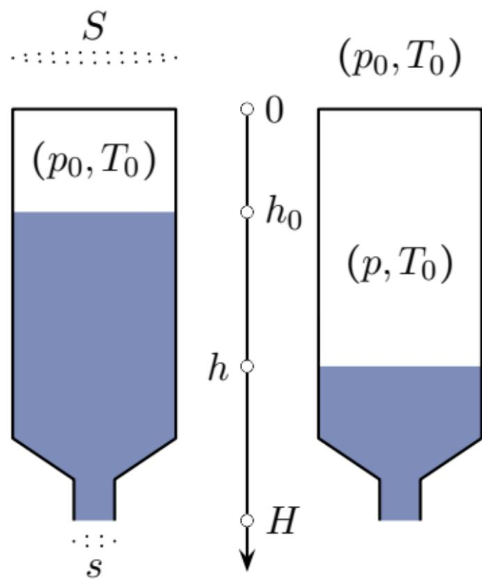
Une bouteille indéformable, partiellement remplie d'eau est subitement retournée. On note  $s$  et  $S$  les sections de l'ouverture et de l'intérieur cylindrique de la bouteille.
