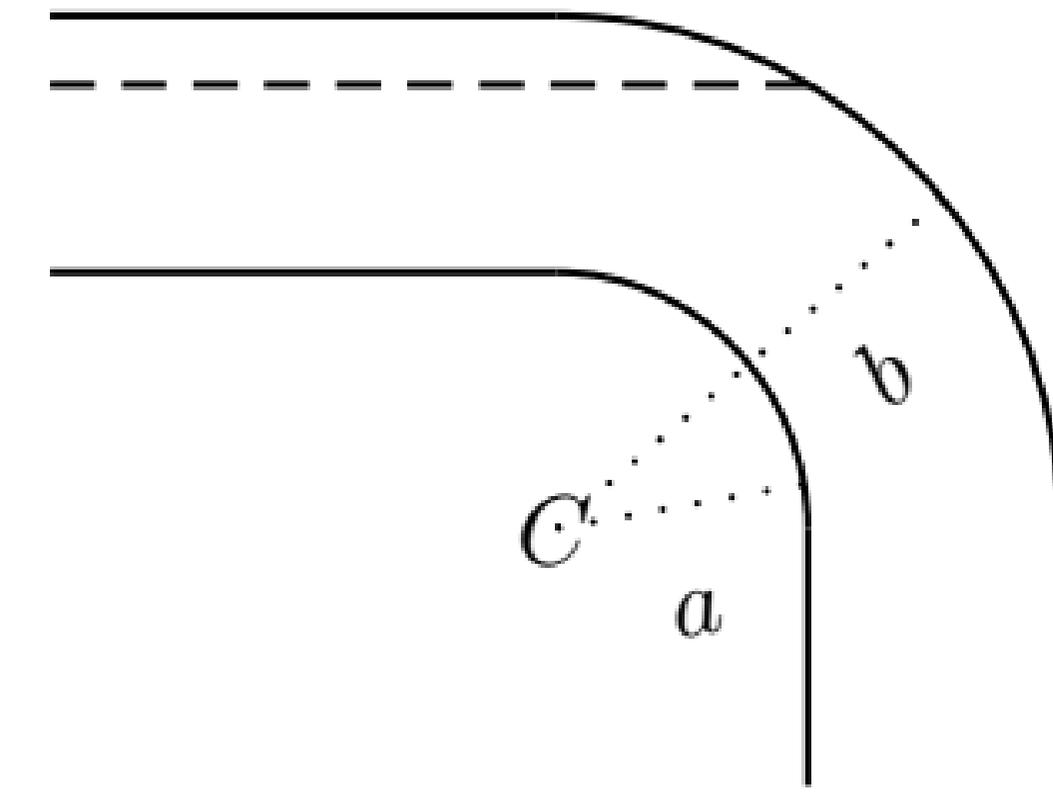
Un faisceau se propage dans une fibre parallèlement à l'axe de la fibre. On courbe alors la fibre. Déterminer la condition sur  $a$  et  $b$  afin que tous les rayons du faisceau soient totalement réfléchis.
