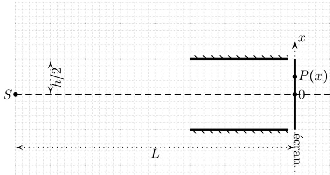
Deux miroirs plans sont éclairés sous une incidence rasante par une source ponctuelle et monochromatique  $S$  ( $\lambda_0 = 0,546\mu m$ ) sur l'axe médiateur des miroirs, à une distance  $L \gg h$  de l'écran. Les miroirs sont placés tels qu'il ne puisse y avoir qu'une réflexion pour un rayon entre  $S$  et  $P$ .
