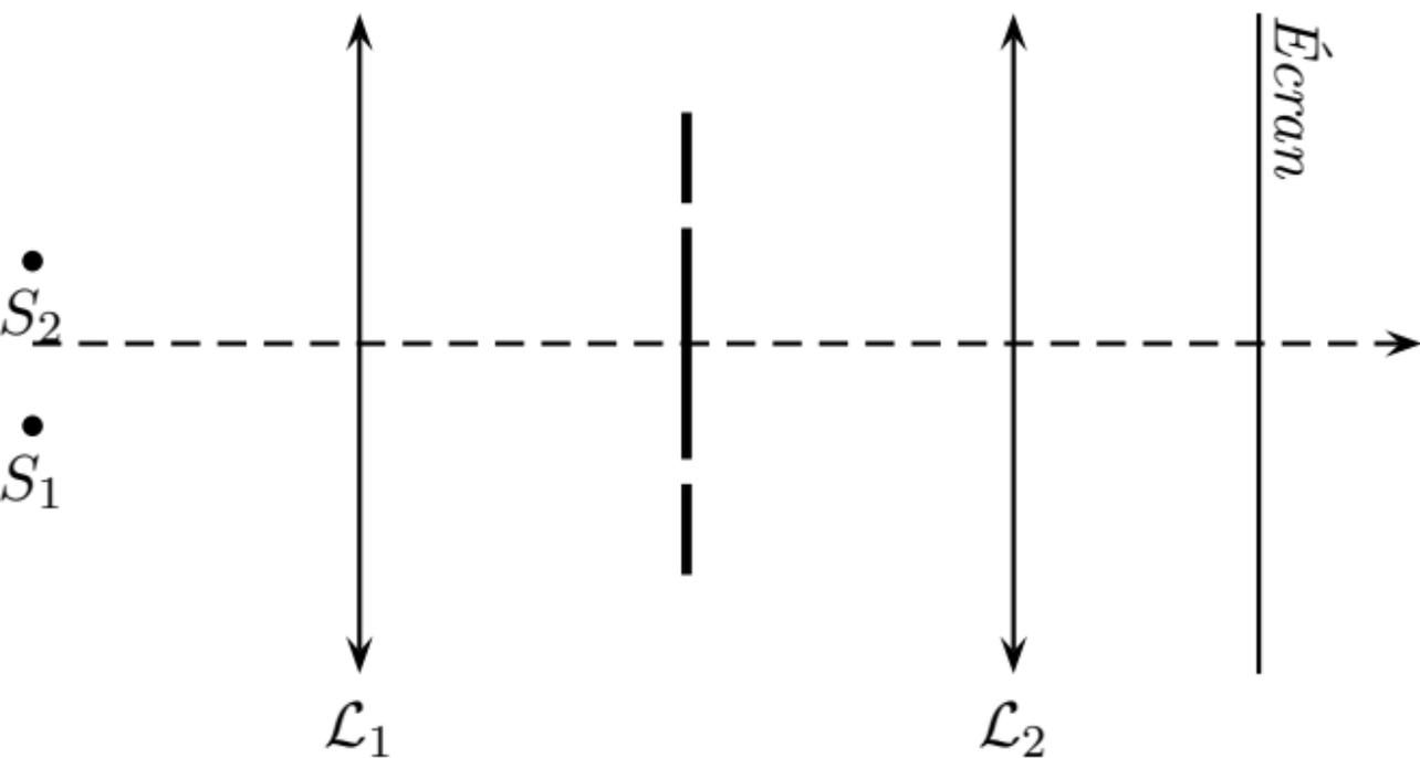
Deux sources monochromatiques ponctuelles ( $S_1$  et  $S_2$ ) sont placées dans le plan focal objet d'une lentille  $\mathcal{L}_1$  ( $f'_1 = 50 \text{ cm}$ ), à une distance  $\pm b$  de l'axe optique. Un dispositif de fentes d'Young de distance entre les fentes  $a$  est placé après la lentille, de manière symétrique par rapport à l'axe optique. On observe la figure d'interférence sur l'écran, dans le plan focal image de  $\mathcal{L}_2$  ( $f'_2 = 33 \text{ cm}$ )
