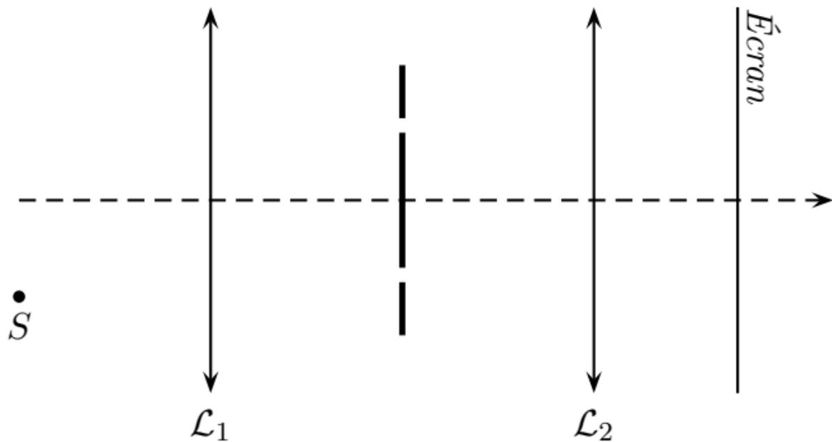
Une source monochromatique ( $S$ ) est placée dans le plan focal objet d'une lentille  $\mathcal{L}_1$  ( $f'_1 = 50 \text{ cm}$ ), à une distance  $\epsilon$  de l'axe optique. Un dispositif de fentes d'Young de distance entre les fentes  $a$  est placé après la lentille, de manière symétrique par rapport à l'axe optique. On observe la figure d'interférence sur l'écran, dans le plan focal image de  $\mathcal{L}_1$  ( $f'_2 = 33 \text{ cm}$ )
