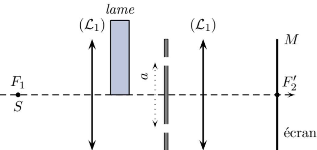
On utilise le dispositif de fentes d'Young distantes de  $a = 0,5 \text{ mm}$  dans les conditions de Fraünhofer. La source  $S$  est une source de lumière verte de longueur d'onde dans le vide  $\lambda_0 = 540 \text{ nm}$ .
