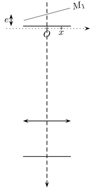
On a recherché la teinte plate pour un interféromètre de Michelson à l'aide d'une lampe à vapeur de sodium. On pourrait alors considérer qu'il n'y a ni coin d'air ni lame d'air. Il subsiste cependant un léger coin d'air  $\epsilon = 1'$  et une légère lame d'air  $e = 100 \text{ nm}$ .
