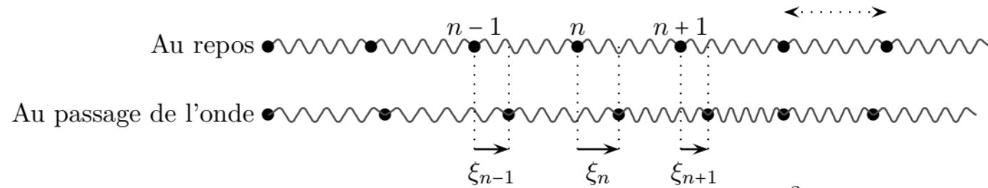
On se place dans l'approximation des milieux continus. On rappelle que  $\ddot{\xi}(x_n, t) - a^2 \frac{K}{m} \cdot \frac{\partial^2 \xi(x, t)}{\partial x^2} = 0$  avec  $c = a \sqrt{\frac{K}{m}}$
